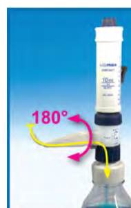
分注頭轉向 180°，啟用防滴液設計，防止液體滴落。
